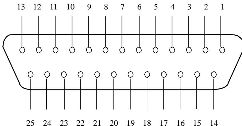
图 2-11 打印接口引脚示意图
