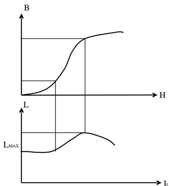
图 3-3 磁场强度、电感量相互关系图
