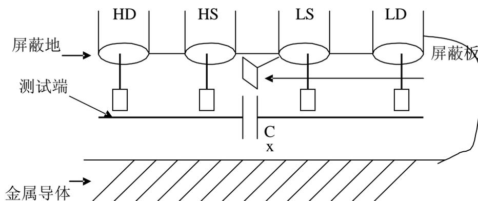
图3-12 消除杂散电容影响方法示意图
