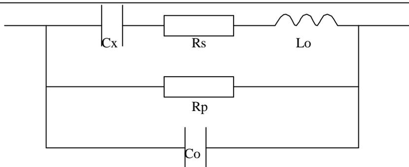
图 2-5 实际电容器分布参数组成情况
