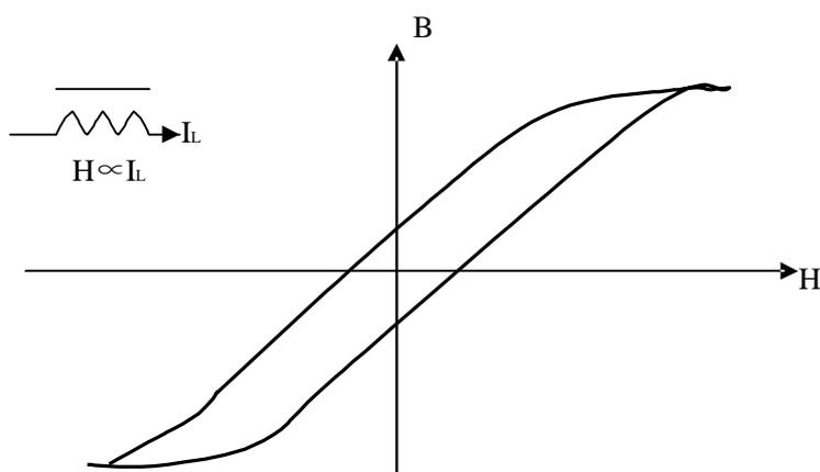
图 3-2 磁芯电感器磁化曲线
