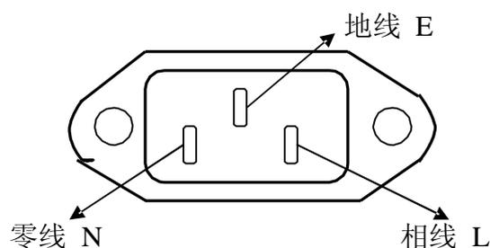
图 3-1 电源插座连接方法（插头的正视图或插座的背视图）
