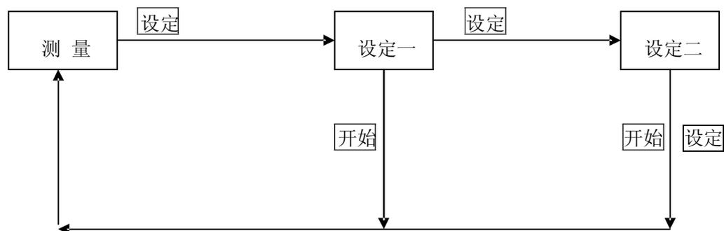
上图中在各状态按 $\triangleleft$ 、 $\triangleright$ 、 $\triangleup$ 、 $\triangledown$  在该状态得到所需相应功能。功能设定完毕必须根据图 2-3 回到“测量”状态方可进行测量操作。
