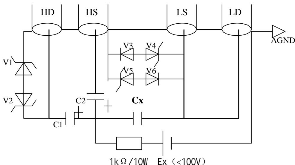
图3-13 施加外部直流偏置电压电路图
