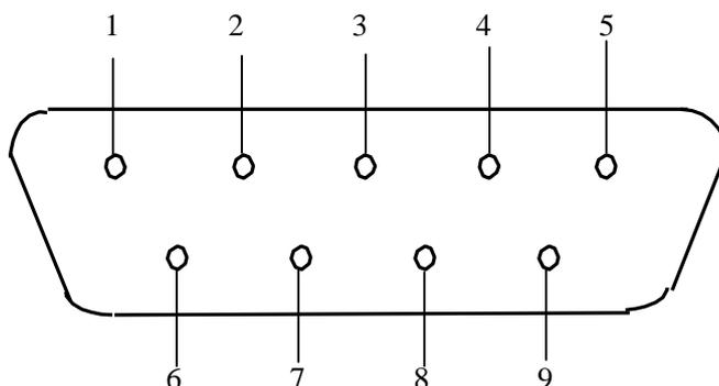
图 2-13 串行接口引脚示意图
