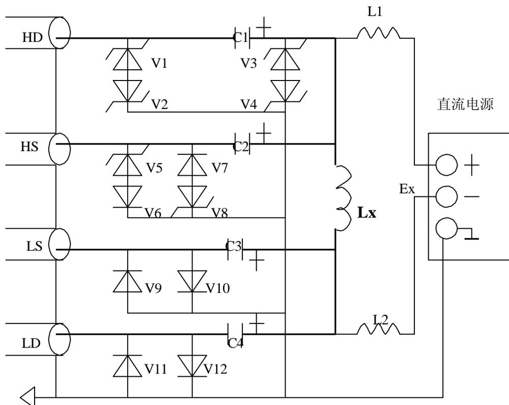
图3-14 施加外部直流偏置电流电路图
